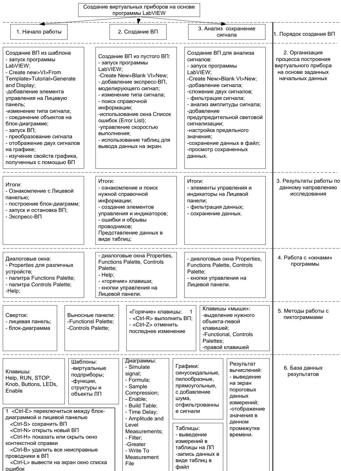
Рис.5 Структурная схема программного комплекса проектирования виртуальных приборов в программе LabView.
