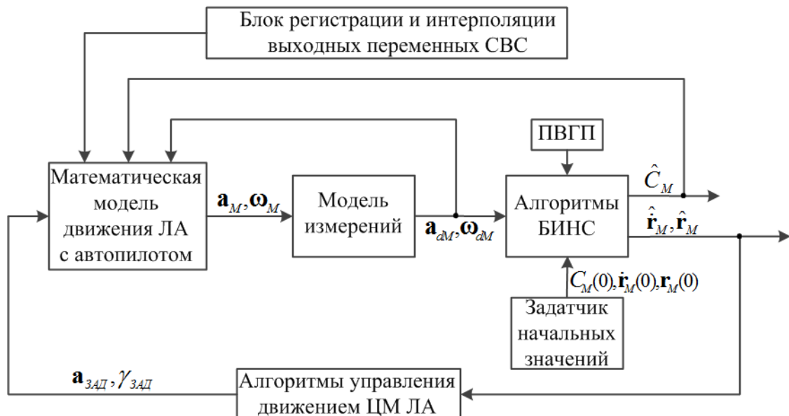
Рис. 12 Функциональная блок-схема имитационной модели САУ
