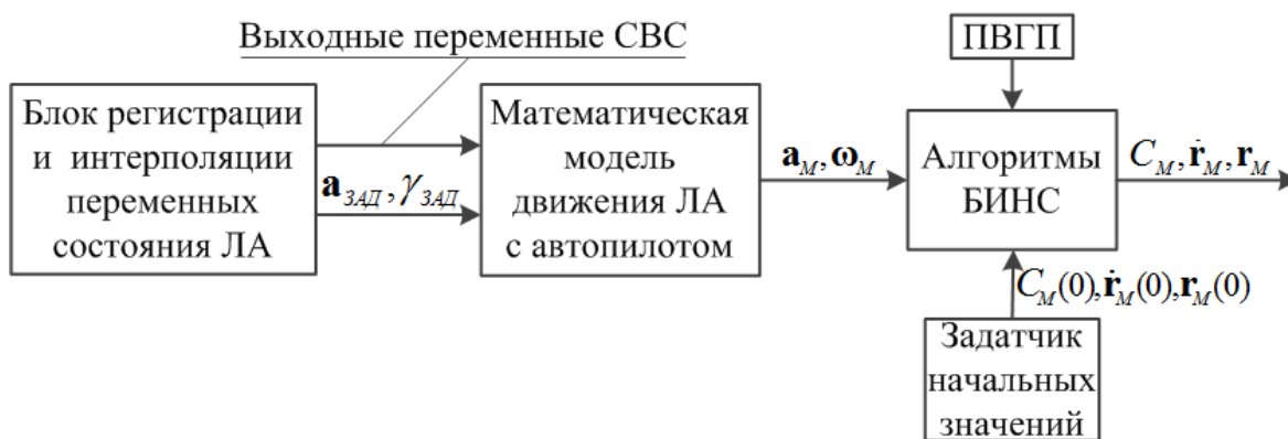
Рис. 10 Функциональная блок-схема системы оценивания входных и выходных переменных БИНС в режиме МАО
