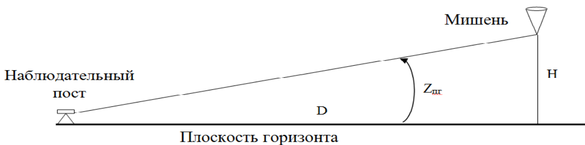
Рис. 2. Схема определения дальности
