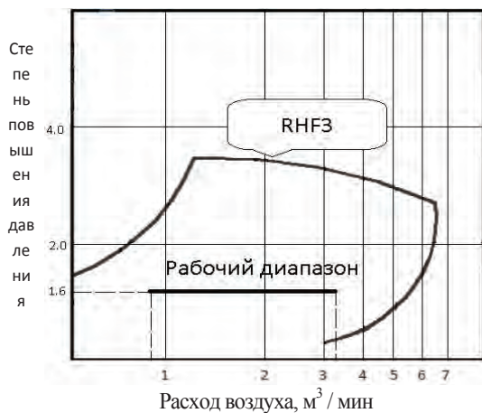
Рисунок 3 – Совмещенные характеристики двигателя и турбокомпрессора RHF3 по расходу воздуха
