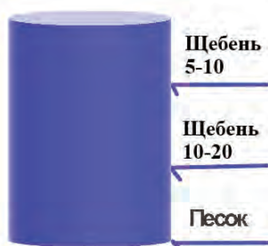
Рисунок 7. Схема расположения слоев заполнителя в цилиндре
