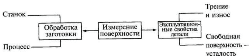
Рис. 4 Место метрологии поверхности в процессах производства и эксплуатации детали
