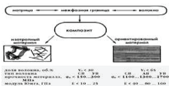
Рисунок 1 – изотропный и ориентированный – свойства при разных наполнителях: стекло,углеродное и арамидное волокно
