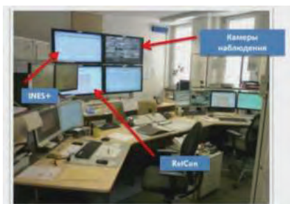
Рис.1. Центральная станция управления светофорными объектами
