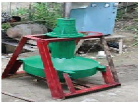
Рис. 2. Изготовленная реактивная гидравлическая турбина для микро ГЭС
