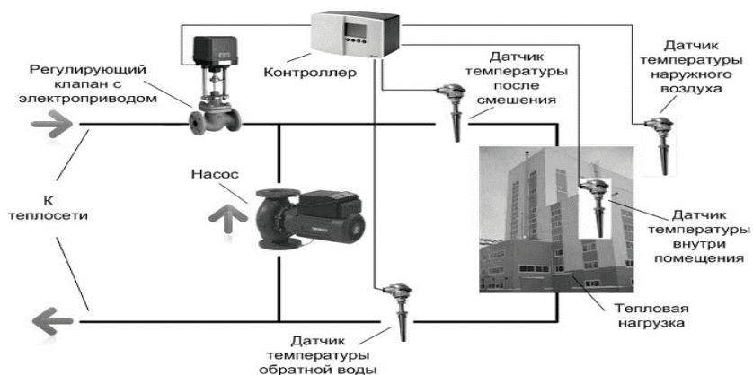
Рисунок № 1 – Схематический рисунок работы автоматизированной системы отопления
