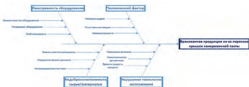
Рисунок 2 - Схема Исикавы «Бракованная продукция из - за перекоса крышки колеровочной пасты»
