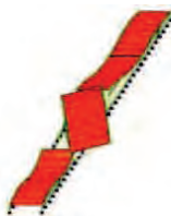
Рис. 3. Изгибно - крутильные деформации каркаса
