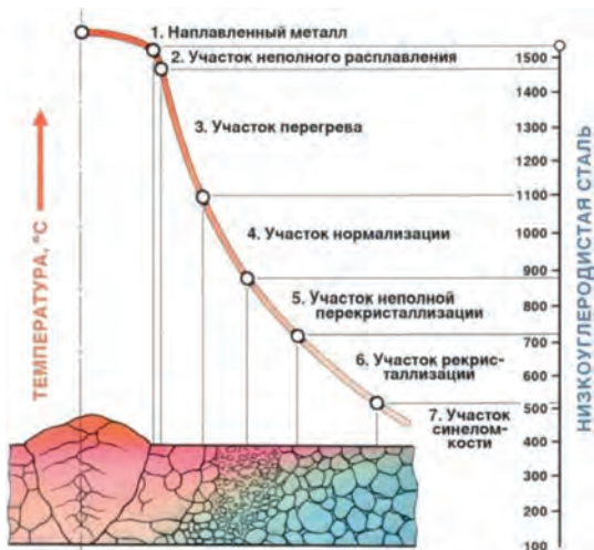
Рисунок 1. Структура металла в зоне термического влияния при сварке низкоуглеродистой стали.
