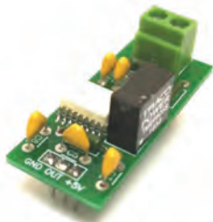
Рисунок 3 – Готовый датчик напряжения
