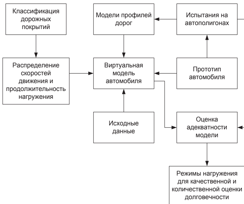
Рис. 2. Алгоритм формирования режимов нагружения элементов подвески автомобилей
