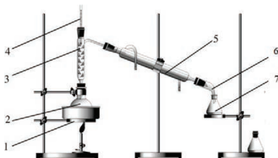
Рис. 1. Установка для фракционной перегонки: 1 - баня с теплоносителем; 2 - круглодонная колба; 3 - дефлегматор; 4 - термометр; 5 - водяной холодильник Либиха; 6 - алонж; 7 - колба - приемник.
