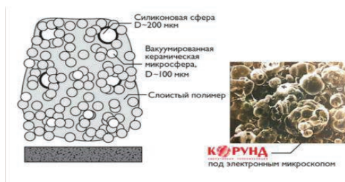
Рис. 1. Строение теплоизоляционного материала КОРУНД [8].
