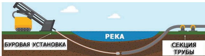
Рисунок 5. Метод установки ГНБ
