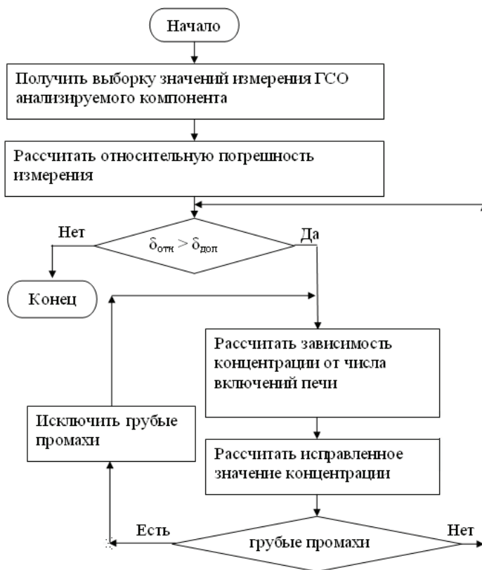
Рис. 1. Блок-схема улучшенного алгоритма обработки данных
