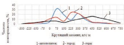
Рис. 1. Распределение крутящего момента на ведущих колесах
