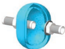
Устройство универсального гасителя гидроудара
