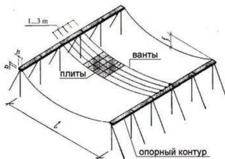
Рис.1. Схема вантового покрытия с висячими балками.
