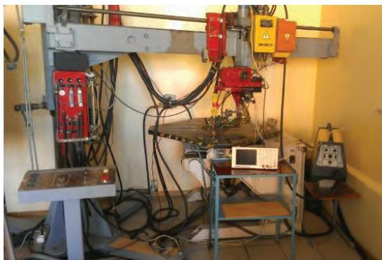
Рис.3. Общий вид установки УПН–303 для плазменной сварки - наплавки плавящимся электродом
