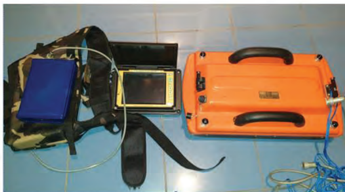
Рисунок 1 – Прибор для георадиолокационного сканирования грунтов - Георадар «ОКО – 2 М» с антенным блоком АБ - 250 МГц
