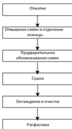
Рисунок 1 - Технологическая схема переработки семян томатов
