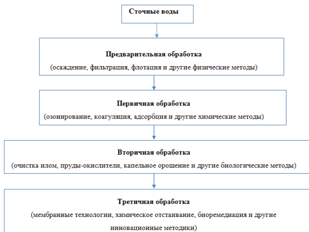
Рис. 1. Методы удаления микропластика из сточных вод
