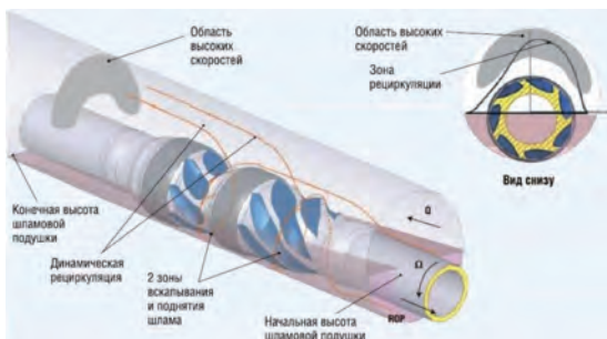
Рис. 1. Принцип работы усовершенствованной бурильной трубы Hydroclean
