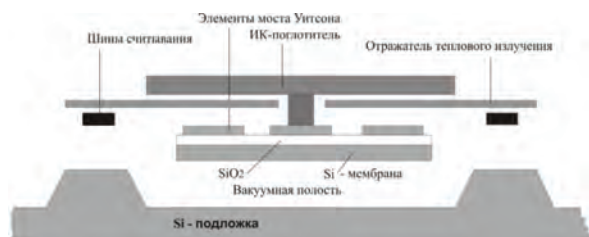
Рис. 1. Типичная конструкция одного пикселя матрицы тепловизора [2].
