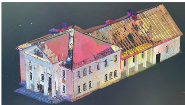
Рисунок 3 Лазерное сканирование с применением БПЛА Источник: разработано автором
