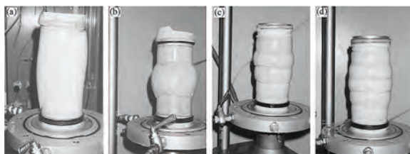
а) без геотекстиля; б) с двумя слоями геотекстиля; с) с тремя слоями геотекстиля; д) с четырьмя слоями геотекстиля
