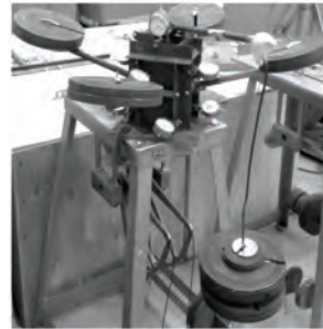
Рис. 11. Общий вид прибора трехосного сжатия для испытания призматических образцов
