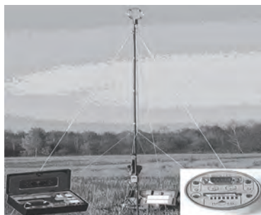
Рисунок 1. - Экспедиционный вариант ультразвуковой метеостанции «Эксметео - 01» для сопровождения полевых исследований
