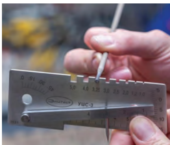
Рис. 1. Общий вид контроля сварочного материала на УШС - 3.
