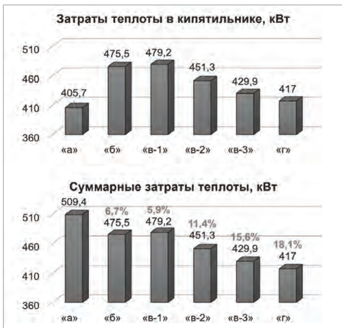
Рисунок 3. Результаты расчета затрат теплоты в кипятильнике и суммарных затрат теплоты для разных вариантов применения ПЦО
