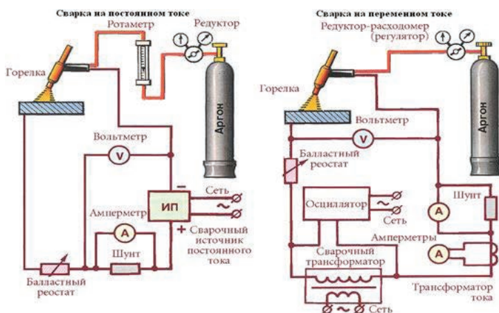
Рисунок 1. К-TIG сварка
