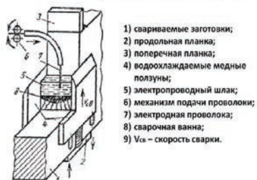
Рисунок 6. Электрошлаковая сварка
