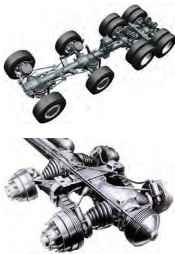
Рис. 1. Хребтовая рама с элементами трансмиссии и ходовой части
