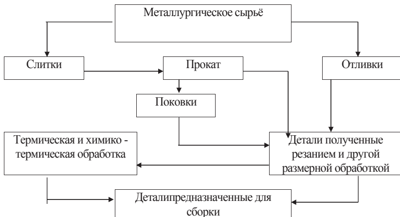
Рис. 1. Принципиальная схема изготовления деталей машин и приборов.
