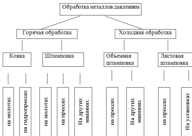
Рис.3. Классификация процессов обработки металлов давлением (ОМД) в машиностроении.
