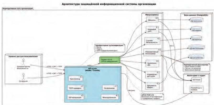
Рисунок 1. Архитектура защищённой микросервисной информационной системы (уровни: пользователи, API - шлюз, сервис - сетка mTLS, семь микросервисов с собственными БД PostgreSQL, уровень мониторинга ELK + Prometheus)
