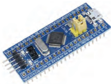
Рисунок 3. Внешний вид отладочной платы GD32
