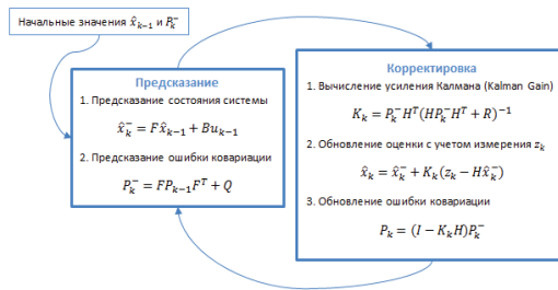
Рисунок 1 – Цикл работы фильтра Калмана
