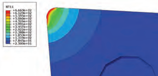
Рис.5. Тепловое поле на передней поверхности
