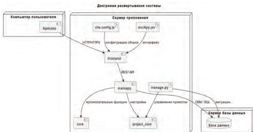
Рисунок 2 – Диаграмма развертывания системы
