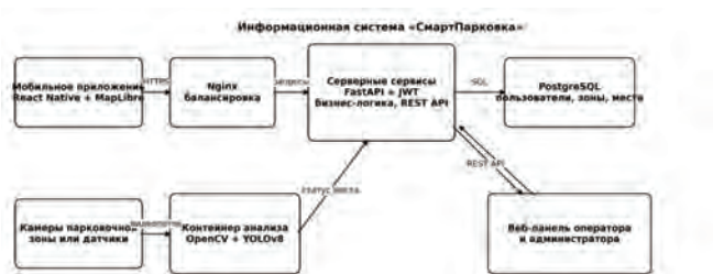
Рисунок 1. Архитектура и поток данных системы «СмартПарковка»
