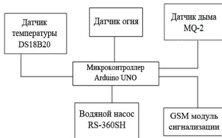
Рисунок 2. Структурная схема пожарной сигнализации на основе платформы Arduino с автоматического установкой пожаротушения
