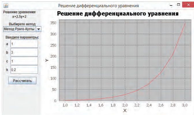
Рисунок 3 - Задание параметров и расчет методом Рунге-Кутты
