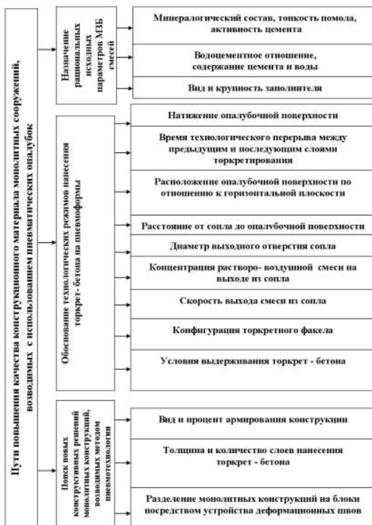
Рисунок 1. Схема повышения качества монолитных конструкций, возводимых на пневмоопалубках
