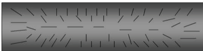
Рисунок 6. Структурирование кокса из пропиточного пека в процессе повторного обжига
