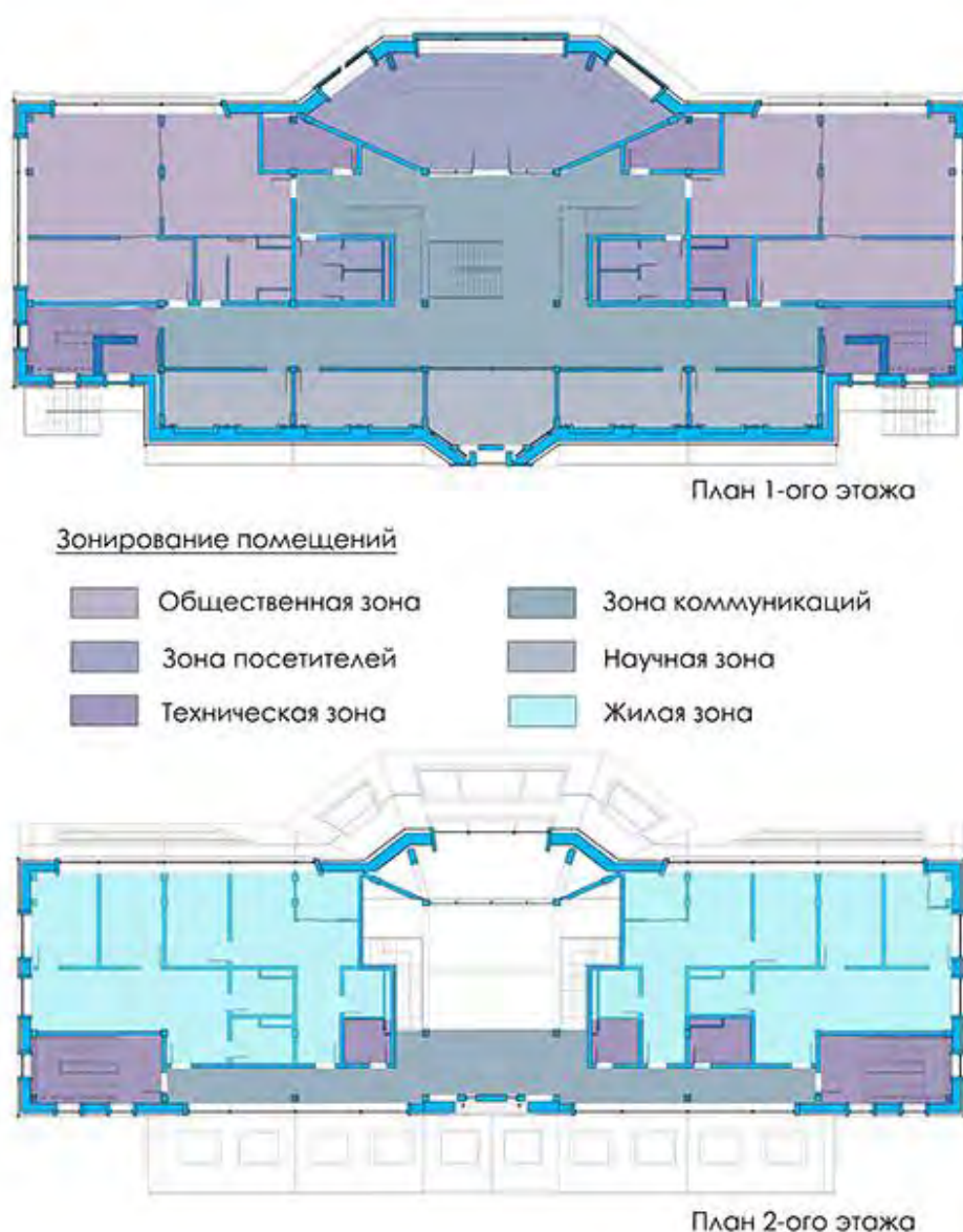
Рисунок 13 – Схема зонирования научного центра овцебыководства в Арктике. [20]
