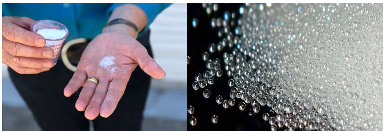
Рисунок 6 – Стекланные микросферы Arctic Ice Project, предназначенные для замедления таяния льдов в Арктике.
