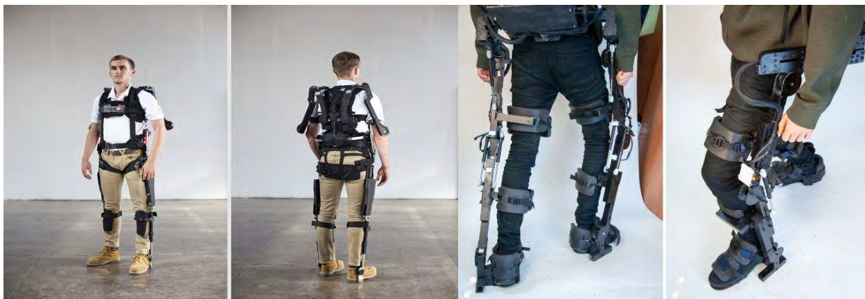
Рисунок 10 – Пример экзоскелета, снижающего физические и психологические нагрузки при работе в экстремальных условиях
