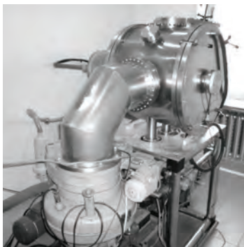
Рис. 1. Экспериментальная установка для ионной имплантации
