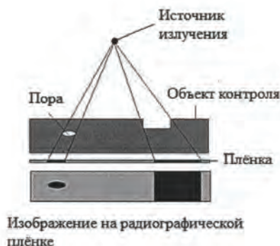
Рис. 1. Схема контроля и получаемое изображение на радиографической плёнке
