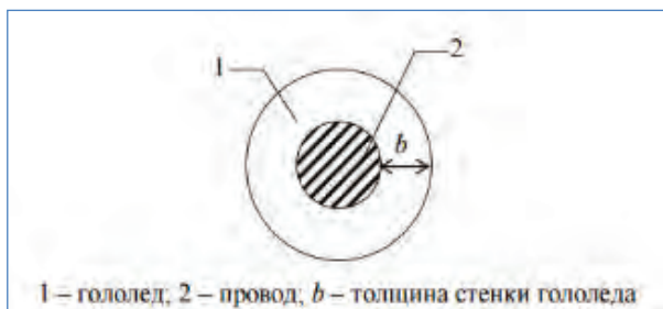
Рис1. Модель образования гололеда на ЛЭП.
