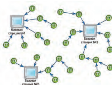
Рис.1.1 - Беспроводная сенсорная сеть сбора данных
