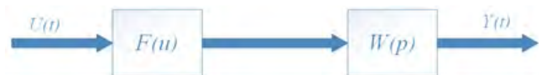
Рисунок 1 – Простая модель Гаммерштейна
