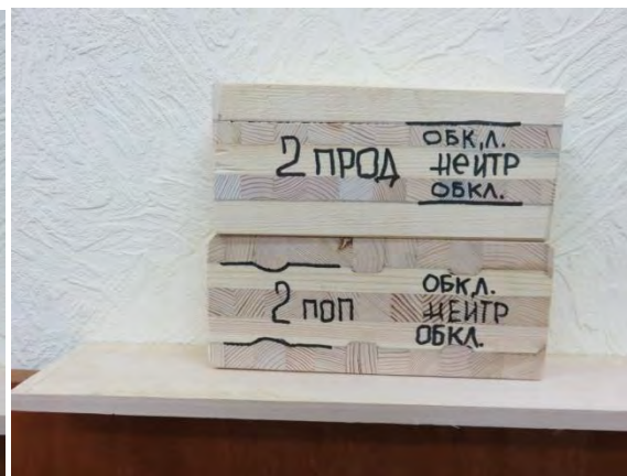
Рисунок 2 – Фото балок, выпиленных из плиты с предварительно напряженным слоем (показан черной линией)
