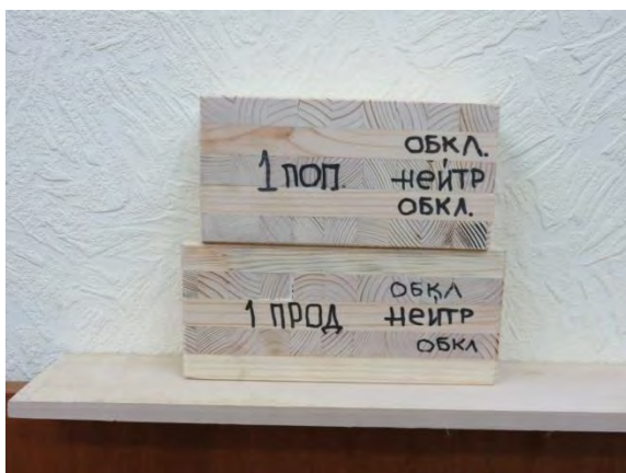
Рисунок 1 – Фото балок, выпиленных из обычной плиты CLT в поперечном (поп.) и продольном (прод.) направлениях
