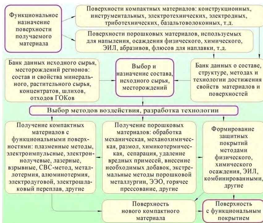
Рисунок 10 – Методологическая схема создания поверхности с функциональным покрытием методом ЭИЛ в условиях материаловедения поверхности.
