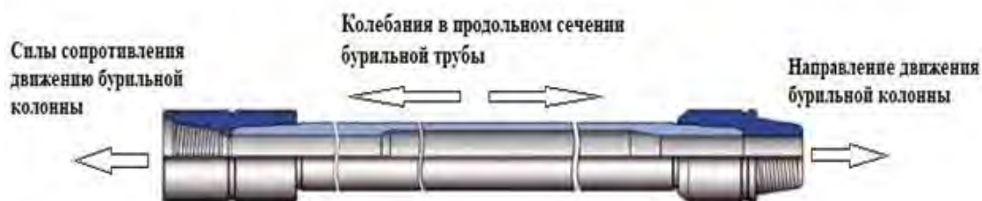
Рисунок 1 – Колебания в продольном сечении
